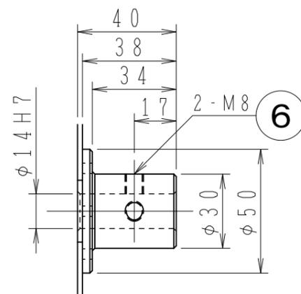
註. ファンバランス取りはブレード面のバランスウェイト取付穴にウェイトを付けて行う。釣合い良さの等級は JIS-B0905 G2.5級 に準ずる。
