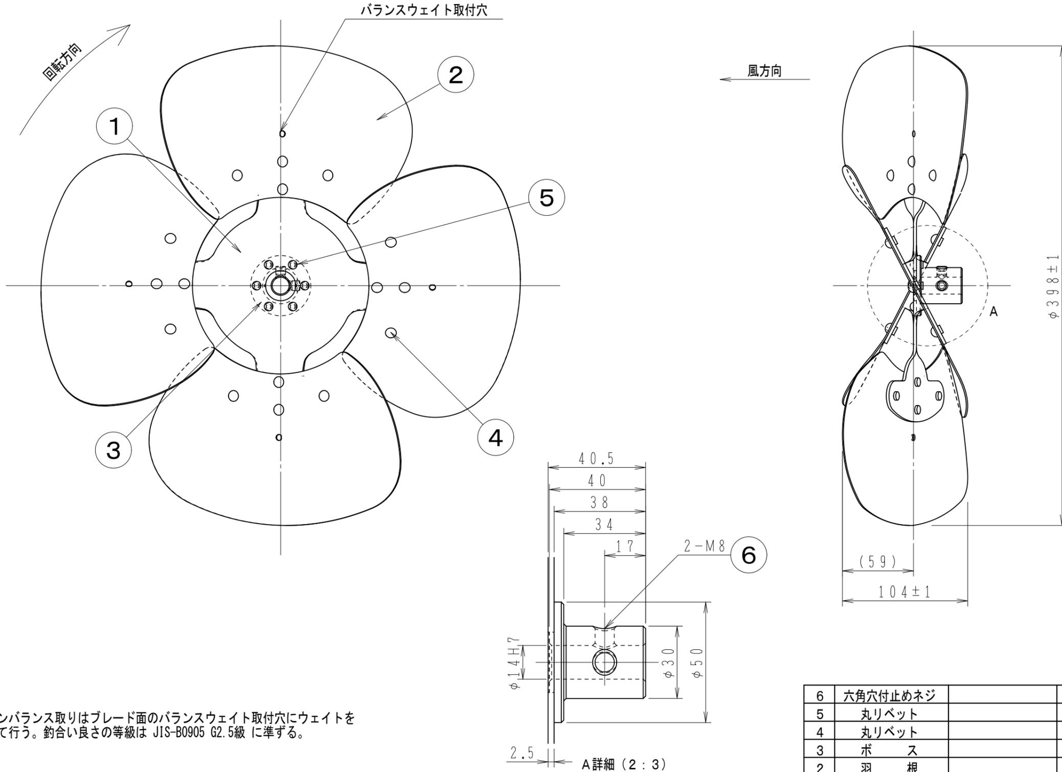
註. ファンバランス取りはブレード面のバランスウェイト取付穴にウェイトを付けて行う。釣合い良さの等級は JIS-B0905 G2.5級 に準ずる。
